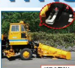
ブラウ取外し ~ 装着ピン解除
