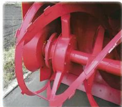
●オーガ油圧クラッチ式シャープレス装置仕様 (運転室内操作復帰型)
